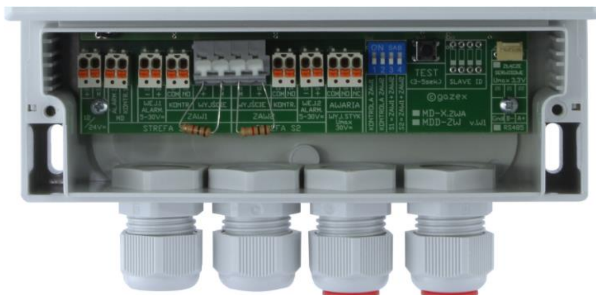
RYS.3.2. ROZMIESZCZENIE ZACISKÓW WEJŚĆ / WYJŚĆ NA PŁYTCIE GŁÓWNEJ, WIDOK PO OTWARTCIU KOMORY ZACISKOWEJ MDX (dostępnych tylko podczas prac instalacyjnych).
