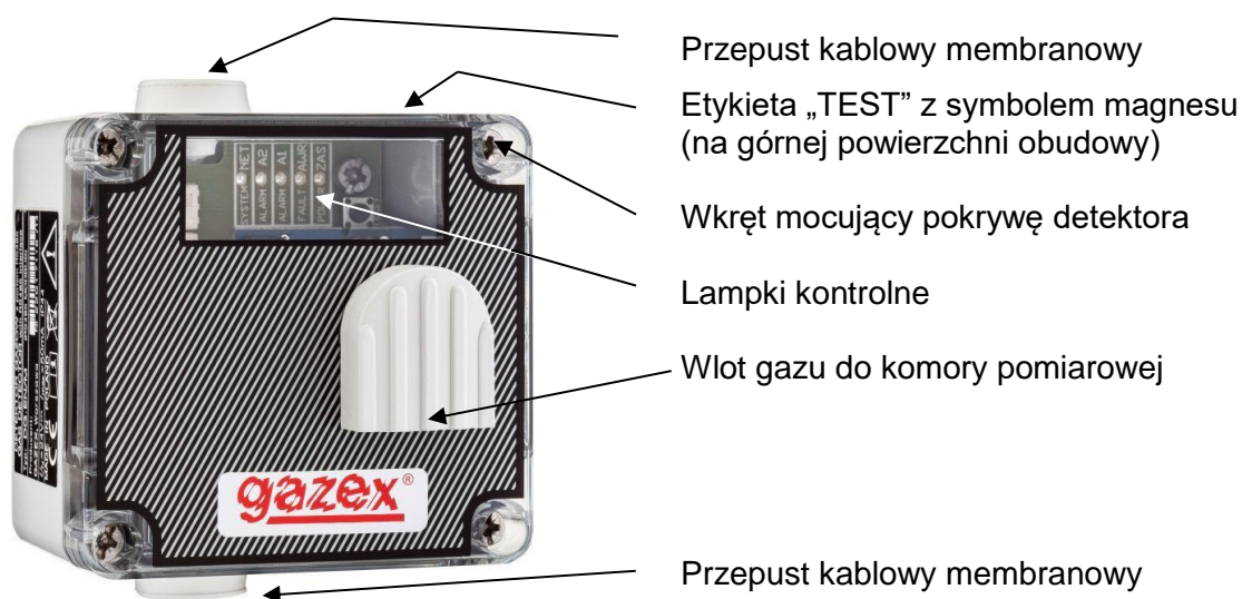
Rys.1.1. Widok DG.EN/M w zalecanej pozycji montażowej.
