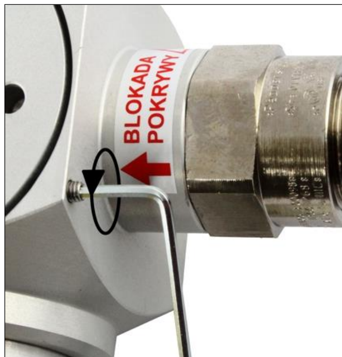
Rys.3.3. PRZED odkręcaniem pokrywy ==> odkręcić wkręt BLOKADY:
